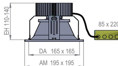
Deckeneinbauleuchte mit LED, LED-Lichtstrom von 1.100 bis 4.000 Lumen, LED-Leistung von 10 – 35 W
