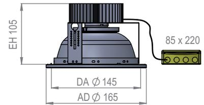
Deckeneinbauleuchte mit LED, LED-Lichtstrom von 1.100 bis 4.000 Lumen, LED-Leistung von 10 – 35 W
